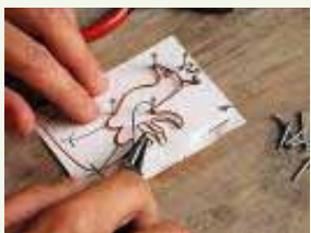
1. La filigrana, invisible a simple vista, es fa amb un fil de coure que reproduceix el dibuix o emblema.
