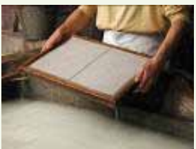
3. La forma se submergeix a la pasta de paper per fer el full.
