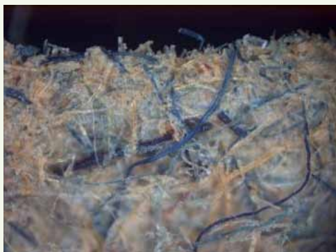
Paper del segle XVIII procedent de l'obra Retrat de Pierre-Louis Laideguive de Quentin de La Tour vist al microscopi. Descobrim fibres de cotó, lli i llana procedents dels draps que intervenen en la seva fabricació.
